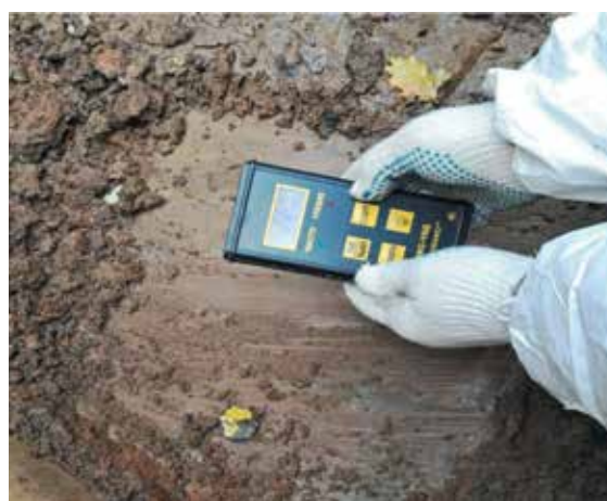
Рис. 6.6 — Дозиметрический контроль поверхностей траншеи
